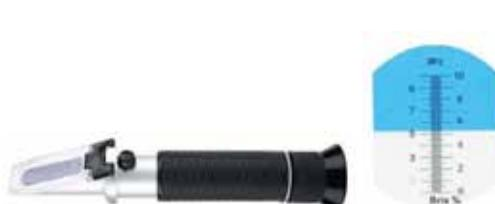
Slika 2. Analogni i digitalni refraktometar s prikazom slike na analognom refraktometru
