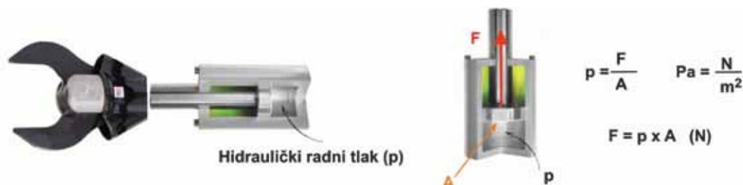
Slika 1. Presjek cilindra hidrauličkog alata sa predmetnim fizikalnim veličinama (F-sila u klipu cilindra alata, p-hidraulički radni tlak, A-površina čela klipa cilindra alata)
