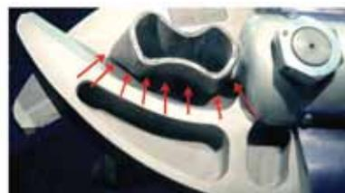
Slika 2. Ispitivanje reznih učinaka vatrogasnih hidrauličkih alata prema EN 13204:2016.
